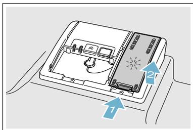
2. Заполнить ополаскиватель до отметки «max»
