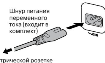
При подключении шнура питания переменного тока автоматически запускается демонстрация (стр. 27). Если вы нажмете кнопку
