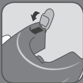
**RU** Закройте пробку водозаборного отверстия.
