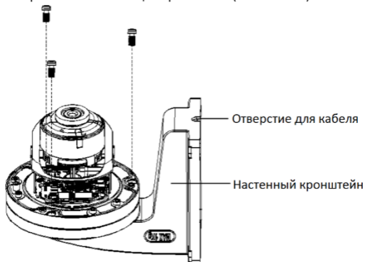
Рисунок 2-11 Установка камеры на настенный кронштейн
