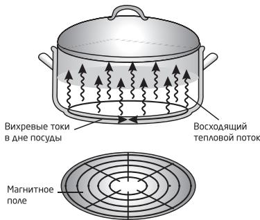
Принцип работы индукционной плиты основан на индукционном нагреве, который представляет из себя нагрев тел в электромагнитном поле за счет теплового действия вихревых электрических токов, протекающих по нагреваемому телу и возбуждаемых в нем благодаря закону электромагнитной индукции.
