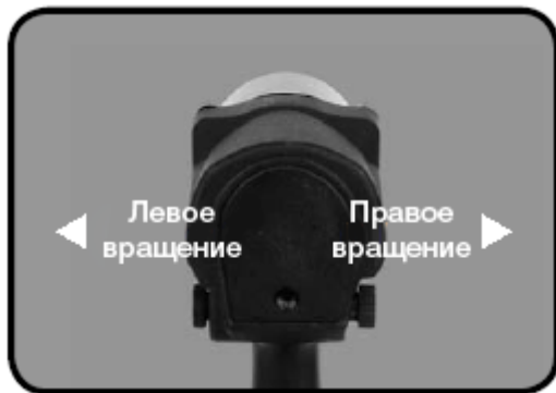
Рисунок 3: Установка направления вращения
