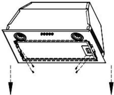
2. Откройте монтажное отверстие в шкафу, вставьте вытяжку в монтажное отверстие в шкафу, затем зафиксируйте вытяжку в шкафу с помощью 12 шурупов.
