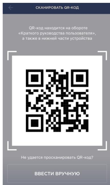
**д.** найти наклейку с QR-кодом на обороте краткого руководства пользователя (идет в комплекте с камерой) либо в нижней части устройства и расположить смартфон на расстоянии 15-20 см от него таким образом, чтобы QR-код полностью попадал в рамку на экране смартфона (см. рисунок слева).
