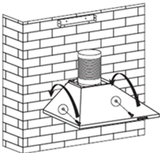
7. Подвесьте вытяжку на саморезы, выровняйте её по горизонту и затяните саморезы отверткой.
