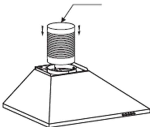
3. Извлеките вытяжку из коробки и аккуратно поставьте на горизонтальный рабочий стол. Установите выходную трубу 120 мм к выходному патрубку и убедитесь, что она плотно присоединена.
