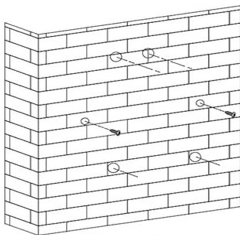
2. Наметьте на стене и просверлите отверстия диаметром 8 мм и глубиной 75~85 мм. Вставьте в отверстия дюбеля. Затяните саморезы 5x60 мм, в дюбели, оставив расстояние между стеной и головкой самореза в 5 мм
