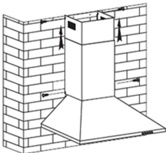
8. Выдвиньте внутреннюю часть короба на высоту саморезов, подвесьте короб на саморезы за фиксирующую скобу. По отверстиям скобы отметить и просверлить 2 отверстия диаметром 8 мм и глубиной 75~85 мм. Далее следует выровнять фиксирующую скобу с отверстиями и затянуть саморезами 5x60 мм.
