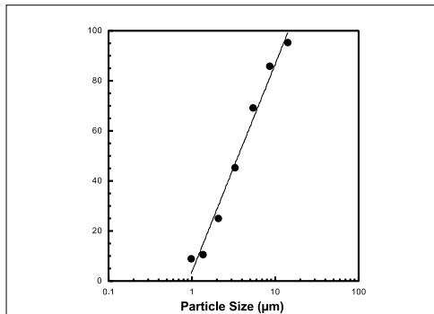
Измерения производились с использованием раствора фторида натрия при помощи импактора нового поколения (Next Generation Impactor = NGI). Поэтому диаграмма может не подходить для суспензий или очень густых медикаментов. Более подробную информацию можно узнать у производителя соответствующего лекарства.
