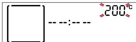
Когда значение на дисплее начнет мигать, поверните ручку регулировки для изменения значения, после чего нажмите OK select для подтверждения выбора и перехода к следующей настройке (при наличии).
