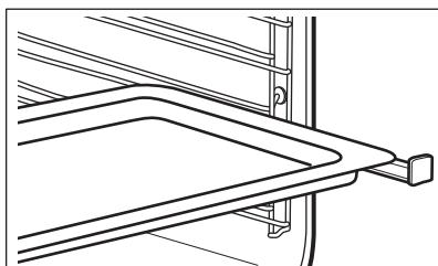
**Одновременная установка решетки и противня для жарки:**
