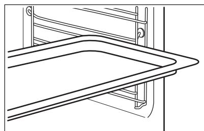
Одновременная установка решетки и эмалированного противня /сотейника:
