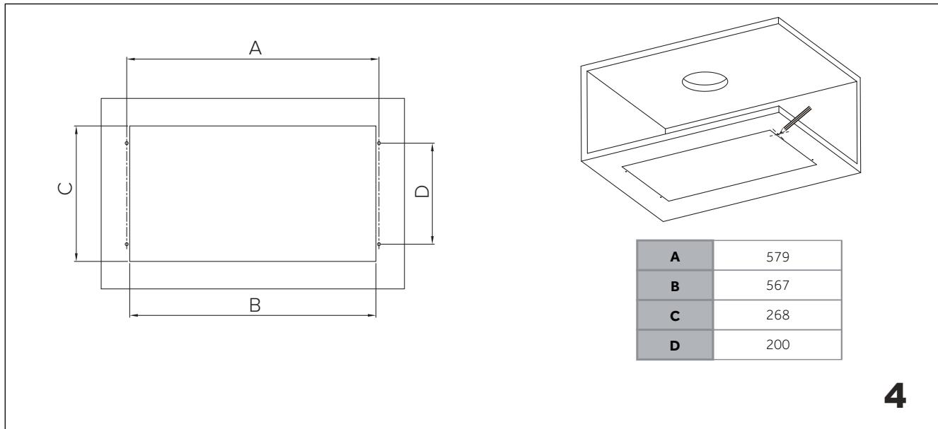
Наметьте размеры для сверления отверстий в зависимости от вашей кухонной вытяжки.
